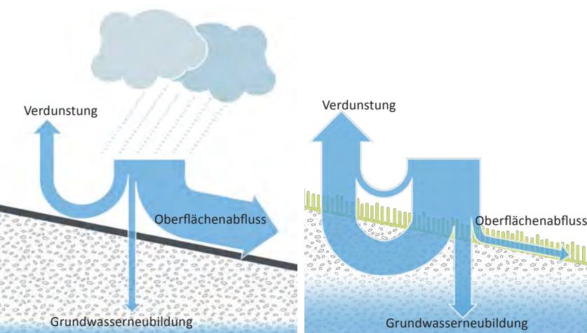
Abb. 4 Wege des Niederschlags auf befestigtem Untergrund (links) und auf einem natürlich bewachsenen Boden (rechts)
