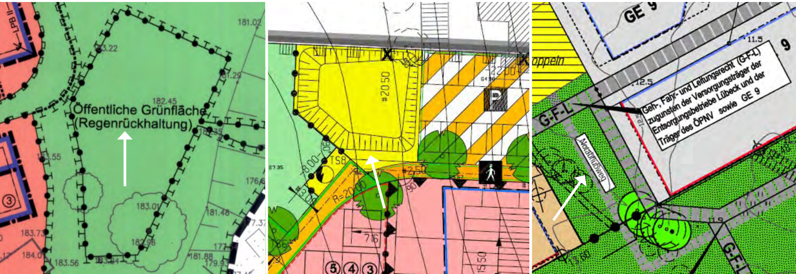
Abb. 42 Möglichkeiten der zeichnerischen Festsetzung von Rückhalteflächen (links), von Versickerungsanlagen (Mitte) und von temporär genutzten Notabflusswegen (rechts) im Bebauungsplan
